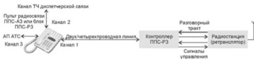
Рисунок 4.5 - Организация радиосвязи при удаленном расположении антенны
