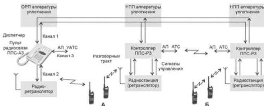
Рисунок 4.6 - Организация радиокабельной системы по каналам аппаратуры уплотнения
