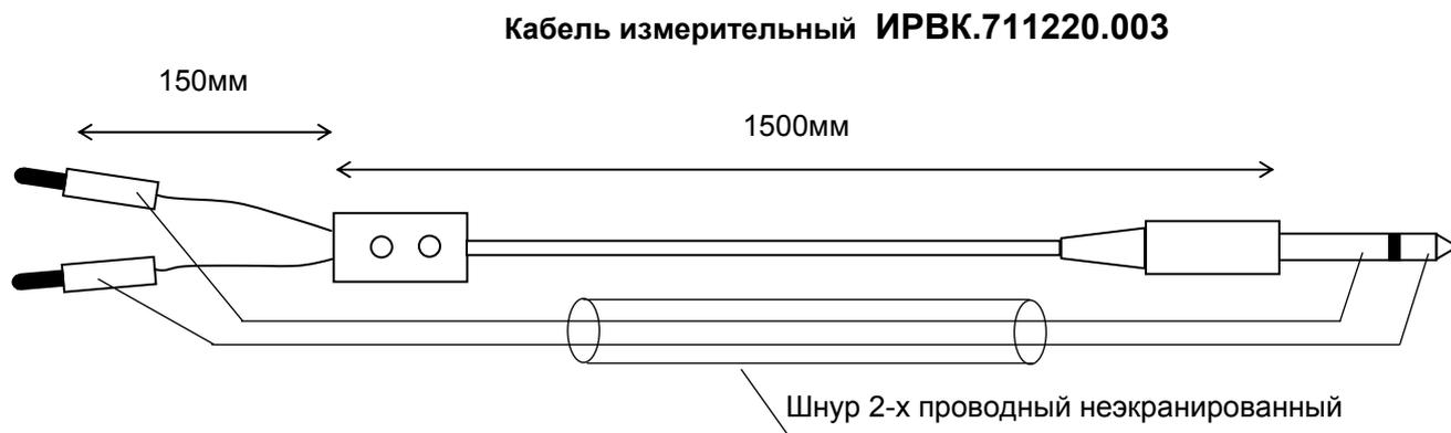
Рисунок 4 - Схема кабеля измерительного изделия
